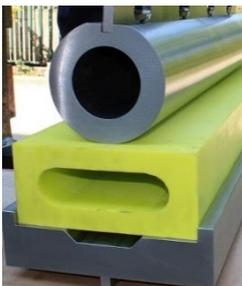
Como una variante de este método está el uso de matrices no estándar, en su lugar se utilizan cajetines soporte de tacos de uretano. Este método puede ser eficaz para doblar incluso "U" con poco esfuerzo, pero requiere de más experiencia del operario para determinar la penetración exacta del punzón para lograr el plegado.
